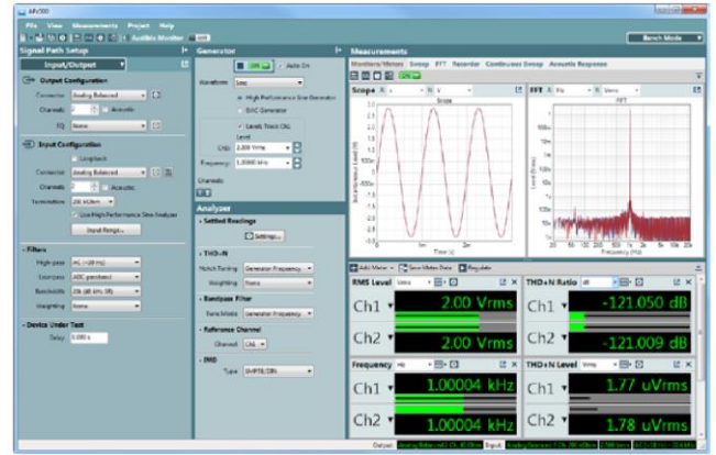
APx500 实时可视模式，实时显示波形、FFT、RMS 电平、频率和 THD+N 仪表和监视器。
